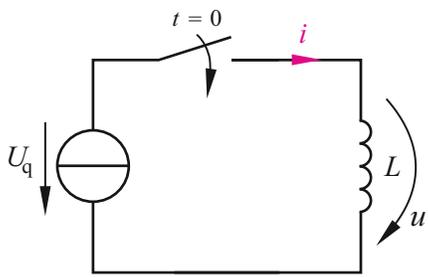
Bild 5.23 Grundeintor  $L$  an konstanter Spannung
