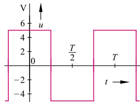
Bild 9.1 Rechteckspannung
